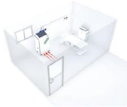
A- Purificateurs d'air autonomes positionnés directement dans la zone opératoire pour la traiter.
