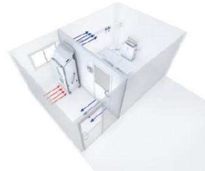
C- Ségrégation de la zone opératoire pressurisée et création d'un espace « sas » par une cloison modulaire « salle propre ».
